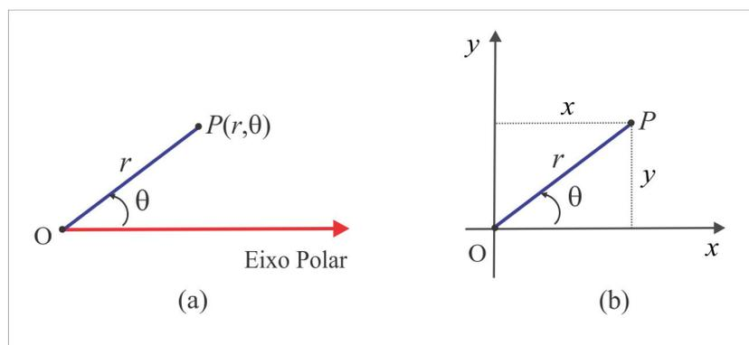
Figura 8.7: Coordenadas Polares  $r$  e  $\theta$ .
